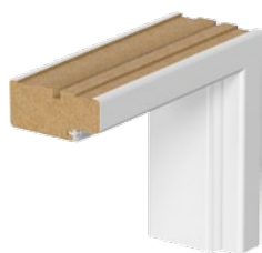
ościeżnica stała typu Minimax 70 So=810 Ho=2075 80 So=910 Ho=2075 90 So=1010 Ho=2075
